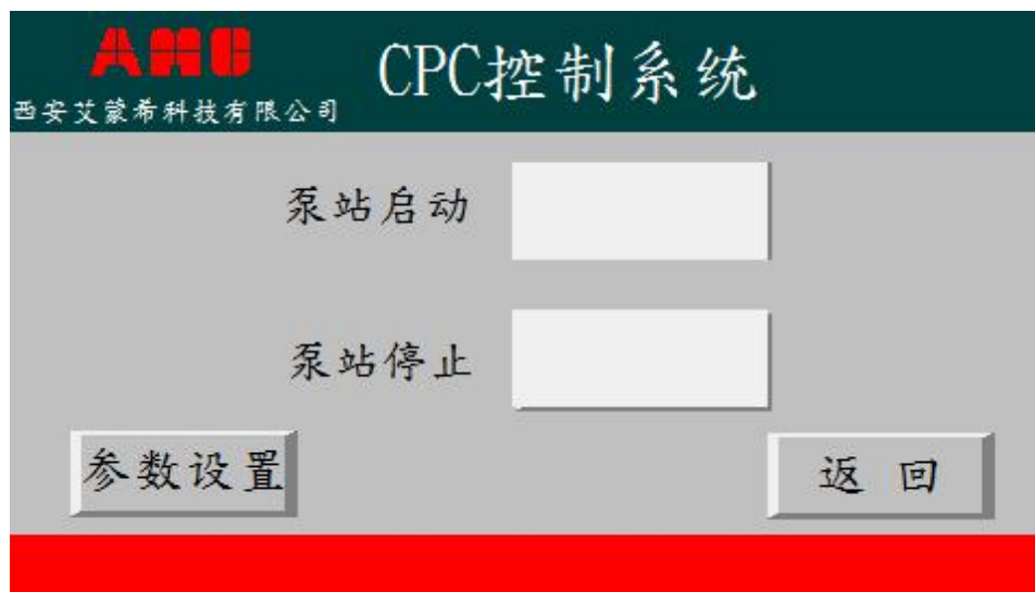
图 3 泵站启停画面
